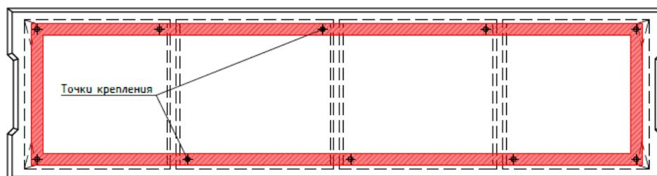
Рисунок 3 - Схема крепления подвесов. Вид сверху
