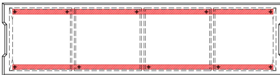
Рисунок 4 - Схема расположения направляющих профилей. Вид сверху
