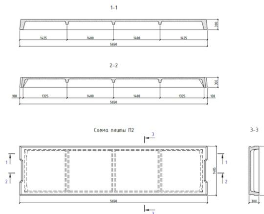
Рисунок 1 - Схема плиты П2
